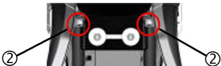
Retire los cuatro tornillos (2) que fijan las cubiertas laterales traseras derecha e izquierda.
