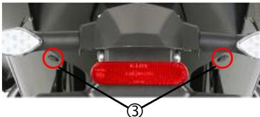
Retire las pestañas (3) conectadas a las cubiertas laterales traseras derecha e izquierda y a la parte inferior de la quilla.
