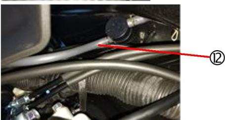
Levante la parte posterior del depósito y retire el tubo de recuperación de los vapores de gasolina (12).
