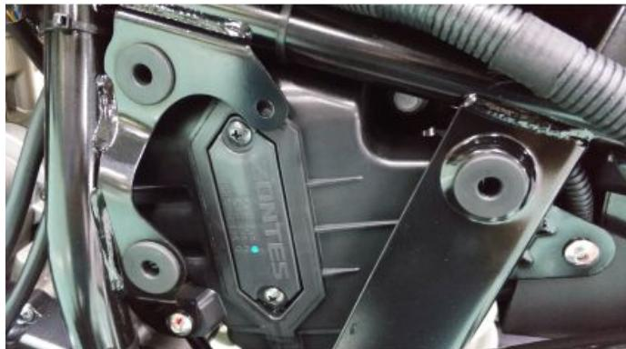
El filtro del aire se encuentra bajo el asiento. Si el filtro del aire está sucio, puede hacer que se obstruya el paso del aire de admisión, baje la potencia y aumente el consumo de combustible. Si conduce en zonas polvorrientas, deberá aumentar la frecuencia de limpieza del filtro del aire o su cambio. Complete los siguientes pasos para realizar la limpieza del filtro del aire.
