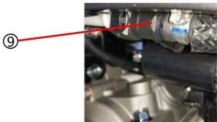
Retire el tubo de gasolina a alta presión (9).
