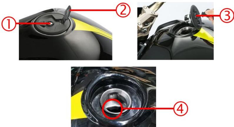
El depósito de gasolina se encuentra delante del asiento. Para repostar gasolina deberá abrir la pestaña ① que cubre la cerradura del tapón, introduzca la llave en la cerradura ② y gire el tapón ③ a la izquierda. Cuando vaya a cerrar el tapón, presione el tapón hacia abajo en la boca de llenado para cerrarlo, y retire la llave.
