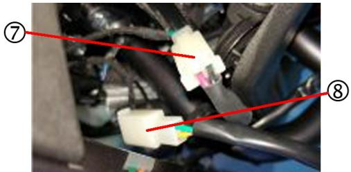
Desconecte el conector USB (7) y desconecte el conector del intermitente izquierdo (8).
