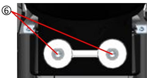
Retire los dos tornillos (6) de los apoyos del asiento, y retire los apoyos del asiento.
