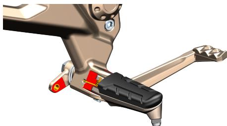
Presione el pedal del freno trasero, la rueda trasera frenará y se iluminará la luz de freno a la vez.
