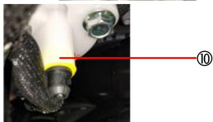
Desconecte el conector de la bomba de gasolina (10).
