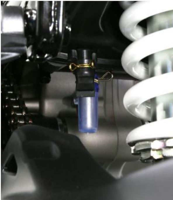
Libere la abrazadera con unos alicates de punta largos. Retire el tubo y vacíe el contenido de aceite en un punto limpio. Vuelva a montar el tubo en su sitio siguiendo el orden inverso.
