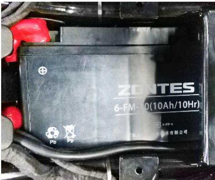
La batería se encuentra debajo del asiento del piloto. Se trata de una batería sin mantenimiento. Para su primer uso, conecte los bornes positivo y negativo y monte el tirante de goma.
