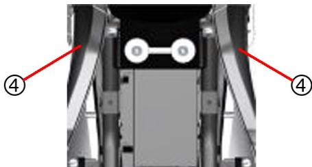
Retire la parte posterior de las cubiertas laterales (4).
