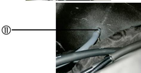
Retire el tubo que absorbe los vapores del depósito de gasolina (11).
