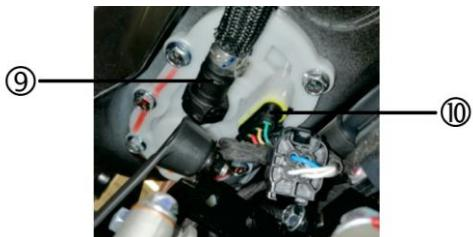
Retire el tubo de gasolina (con presión) de la bomba (9) y el conector de la bomba de gasolina (10).
