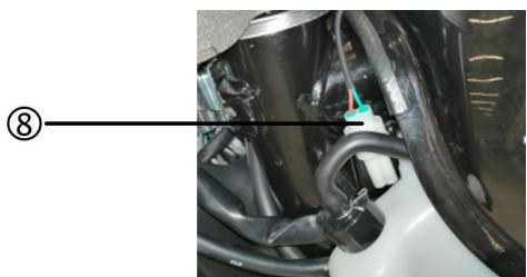
Retire el conector del cable de apertura de la tapa del depósito de gasolina (8).
