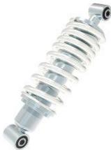
El muelle del amortiguador trasero se ajusta según las necesidades de conducción, la carga y el estado de la carretera. Para ello solo necesita detener la motocicleta con el caballete lateral. Ajuste la precarga del muelle a la posición deseada. La rigidez disminuirá cuando lo ajustemos hacia abajo y aumentará cuando lo ajustemos hacia arriba.
