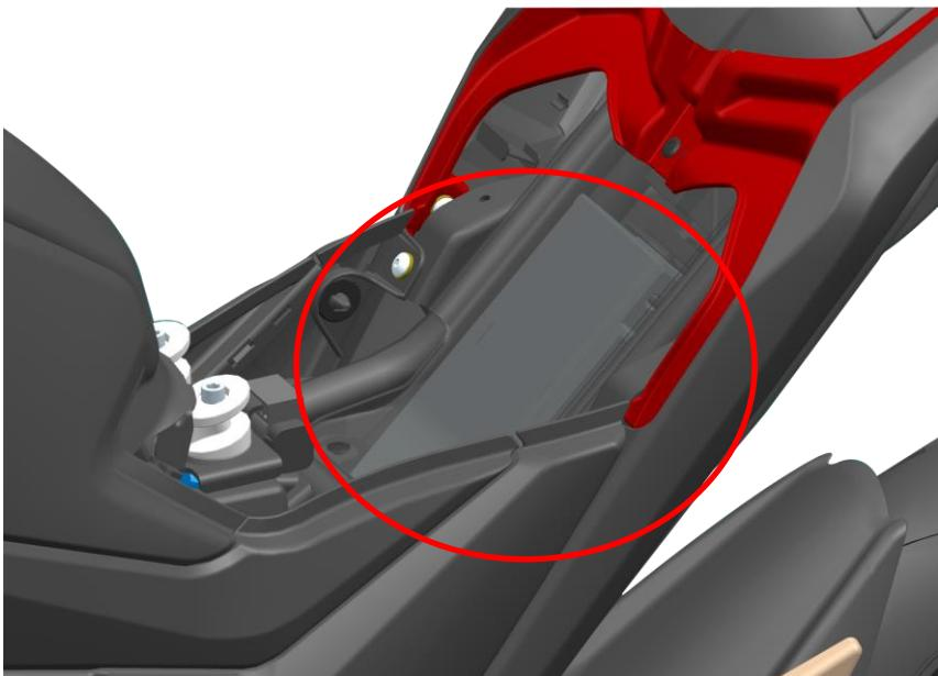
La batería se encuentra debajo del asiento del piloto. Se trata de una batería de gel-plomo sin mantenimiento. Para su primer uso, conecte los bornes positivo y negativo y monte el tirante de goma.
