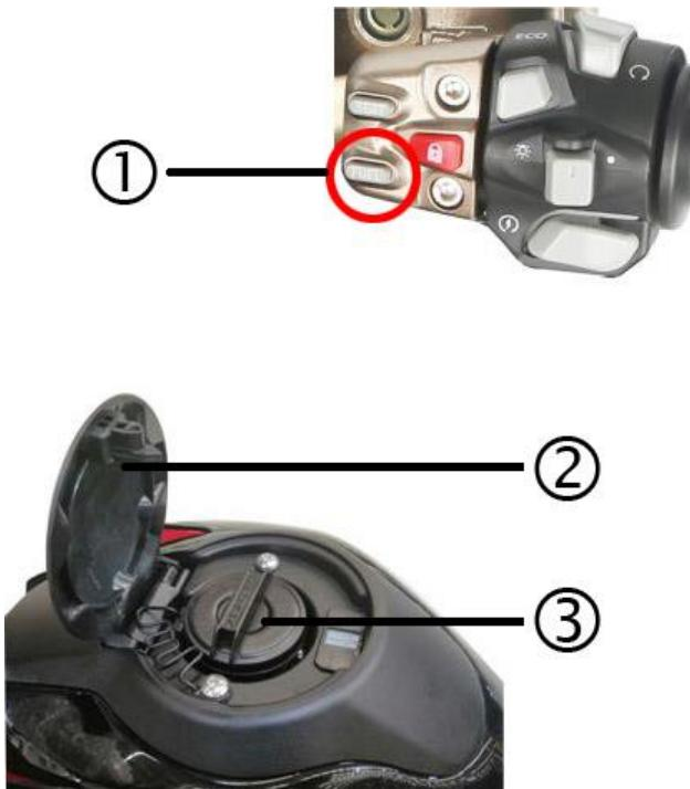
El depósito de gasolina se encuentra delante del asiento. Para repostar gasolina deberá abrir la tapa de acceso al tapón. Asegúrese de que el motor esté parado, y pulse el botón del depósito de gasolina (1), la tapa (2) se abrirá automáticamente, gire el tapón (3) del depósito de gasolina en sentido antihorario. Para cerrar el depósito, siga el orden opuesto al descrito.
