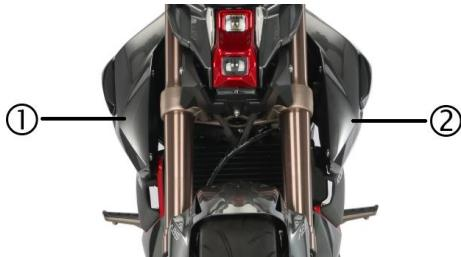
Desmonte las pestañas de fijación, (1) y (2), entre la cubierta exterior del depósito y los aletines laterales del carenado.
