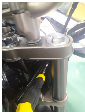
Ajuste de la altura del haz del faro
