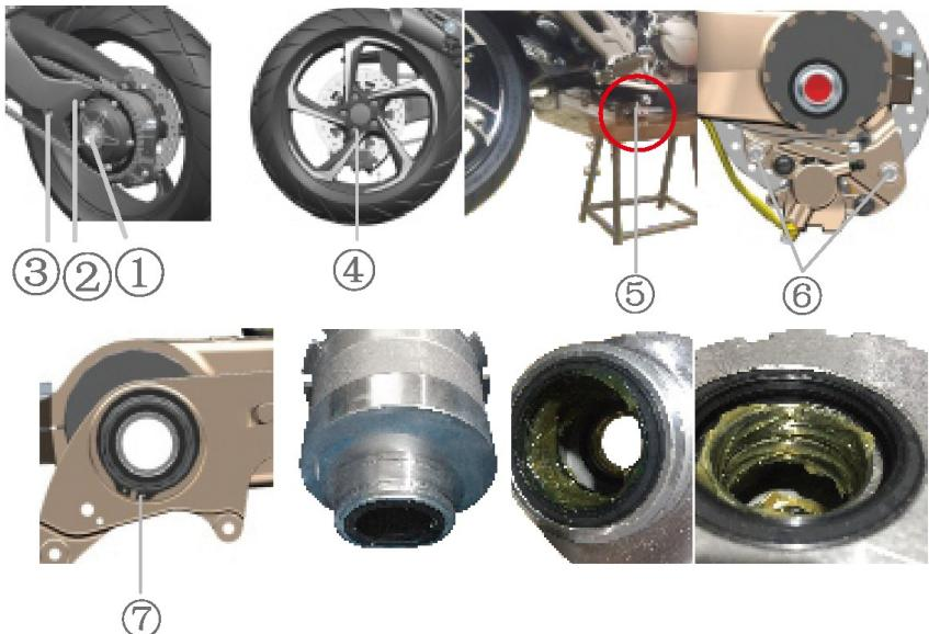
1. Retire el pasador de la tuerca almenada del eje trasero (1), y luego afloje la tuerca M35 (par de apriete 200 Nm). Cuando lo afloje, el buje del disco de freno debe estar apretado para evitar que gire. Tenga en cuenta que no es necesario retirar la tuerca M35.
