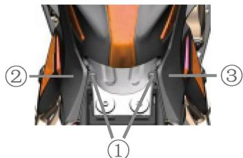
2. Retire las garras de la cubierta exterior del depósito y ambas cubiertas laterales izquierda y derecha (1).
