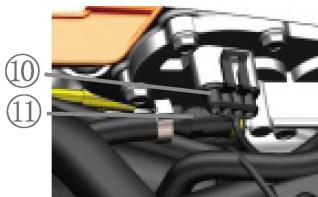
12. Retire el conector de la bomba de gasolina (10).
