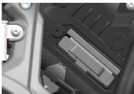
El filtro del aire se encuentra bajo el asiento. Si el filtro del aire está sucio, puede hacer que se obstruya el paso del aire de admisión, baje la potencia y aumente el consumo de combustible. Si conduce en zonas polvorrientas, deberá aumentar la frecuencia de limpieza del filtro del aire o su cambio. Complete los siguientes pasos para realizar la limpieza del filtro del aire.
