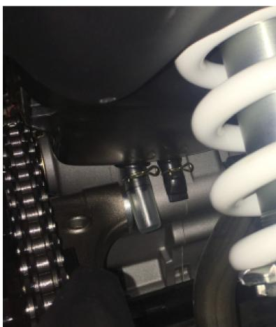
Apriete el extremo redondo del pasador de unión, baje el tubo de drenaje de aceite usado. Libere la abrazadera con unos alicates de punta largos. Retire el tubo y vacíe el contenido de aceite en un punto limpio. Vuelva a montar el tubo en su sitio siguiendo el orden inverso.
