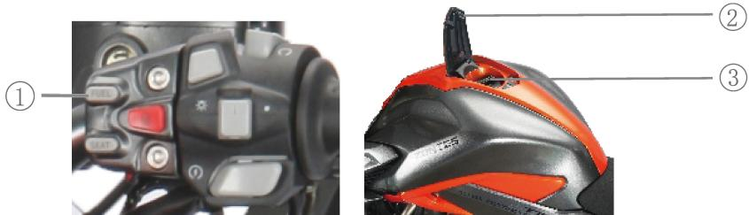
El depósito de gasolina se encuentra delante del asiento. Para repostar gasolina deberá abrir la tapa de acceso al tapón. Asegúrese de que el motor esté parado, y pulse el botón de apertura de la tapa del depósito de gasolina (1), la tapa (2) se abrirá automáticamente, gire el tapón (3) del depósito de gasolina en sentido antihorario. Para cerrar el depósito, siga el orden opuesto al descrito.
