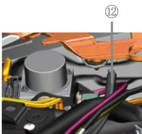
13. Retire el tubo de aspiración de los vapores de la gasolina (12)..
