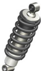
El muelle del amortiguador trasero se ajusta según las necesidades de conducción, la carga y el estado de la carretera. Para ello solo necesita detener la motocicleta con el caballete lateral. Ajuste la precarga del muelle a la posición deseada. La rigidez disminuirá cuando lo ajustemos hacia abajo y aumentará cuando lo ajustemos hacia arriba.
