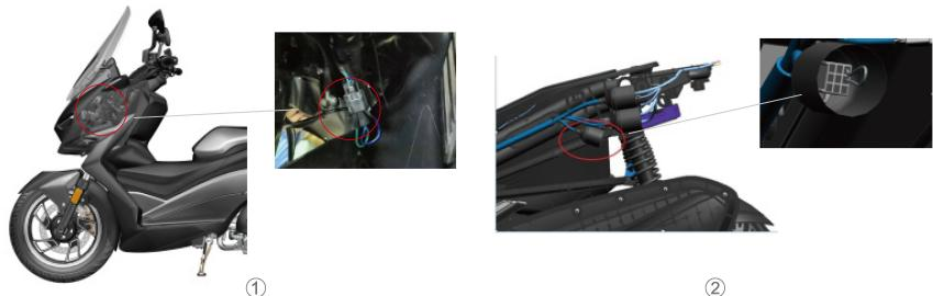
Este vehículo cuenta de serie con un conector situado en la parte posterior izquierda del bastidor como muestra la Figura 1. El conector es impermeable y suministra energía sólo cuando el motor está en marcha, pudiendo conectarse faros auxiliares sin dañar los circuitos eléctricos originales.
