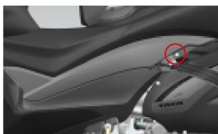
Retire el tornillo de fijación de la cubierta del lado izquierdo, retire con cuidado la cubierta del lado izquierdo y retire la cubierta del lado derecho de la misma manera.
