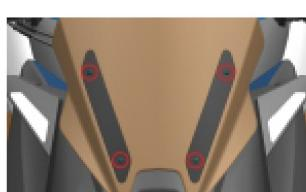
Abra la tapa exterior del depósito de gasolina, afloje los tornillos de fijación de la tapa del depósito de gasolina, desconecte el conector del cierre del depósito de gasolina, retire la tapa del depósito de gasolina y el centro de la tapa, cubierta y tapón del depósito de gasolina, y, en la parte central de la cubierta del depósito de gasolina, la cubierta del depósito está finalmente apretada a la boca de llenado.
