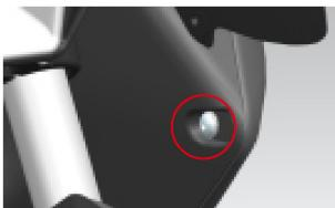
Utilice un destornillador plano para despegar por la parte indicada y retirar la alfombrilla izquierda trasera y la goma izquierda trasera. Proceda a retirar los ocho tornillos y las dos garras de unión.
