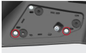
Retire la garra de unión y los dos tornillos, retire la moldura decorativa del panel de la guantera.
