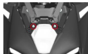
Retire los dos tornillos y retire el panel frontal delantero.
