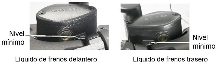
Compruebe el nivel de líquido de frenos en los depósitos de las bombas de freno delantera y trasera. Si el nivel del líquido de frenos está por debajo de la marca LOWER, compruebe el desgaste de las pastillas y si aparecen fugas de líquido de frenos.
