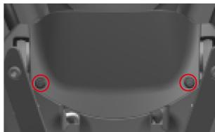
Retire las dos garras y saque la visera del panel de instrumentos.
