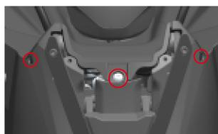
Retire las dos garras, retire un tornillo y retire el escudo frontal.
