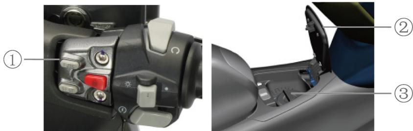
El depósito de gasolina se encuentra en el centro del vehículo. Cuando abra el tapón del depósito de gasolina deberá poner el interruptor cortacorrientes en OFF, pulse el botón de apertura del depósito de gasolina (1) y la tapa del depósito (2) se abrirá automáticamente; después gire el tapón del depósito (3) a la izquierda. Cuando vaya a cerrar la tapa después de repostar, ponga el tapón (3) sobre la boca de llenado y gírelo a la derecha.
