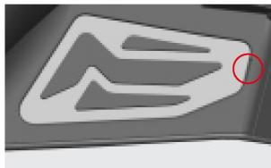
Utilice un destornillador plano para despegar por la parte indicada y retirar la alfombrilla izquierda delantera y la goma izquierda delantera; proceda a retirar los dos tornillos.
