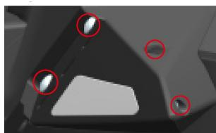
Retire la garra de unión, retire los dos tornillos y un tornillo auto-rosante. Libere el intermitente izquierdo.
