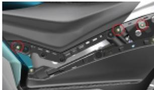
Retire los tres tornillos y retire suavemente la tapa del depósito de gasolina de derecha a izquierda; retire la parte izquierda de la tapa del depósito de gasolina.
