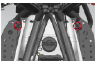
Desconecte el tubo de gasolina a alta presión, el tubo de absorción del cánister y el conector del aforador de gasolina del depósito
