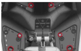
Retire las dos garras que fijan el canalizador de aire del electroventilador y saque el canalizador de aire del electroventilador
