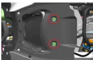
Abra las cajas de las guantera izquierda y derecha, afloje los seis tornillos y retire el panel de la guantera frontal como un conjunto
