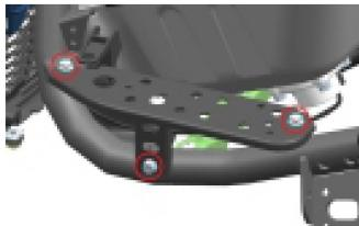
Retire los tres tornillos que fijan la placa de apoyo de la plataforma izquierda y retire la placa de apoyo de la plataforma izquierda.
