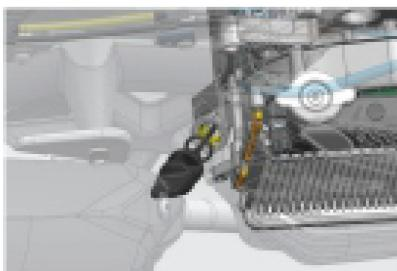
5. Monte el filtro de aceite, muelle, junta tórica y tapa del cartucho del filtro de aceite y apriételo al par especificado (par de apriete: 25 Nm).
