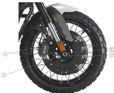
Par de apriete del eje delantero: 65 Nm
