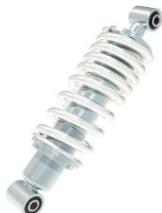
El muelle del amortiguador trasero se ajusta según las necesidades de conducción, la carga y el estado de la carretera. Para ello solo necesita detener la motocicleta con el caballete lateral. Ajuste la precarga del muelle a la posición deseada. La rigidez disminuirá cuando lo ajustemos hacia abajo y aumentará cuando la ajustemos hacia arriba.
