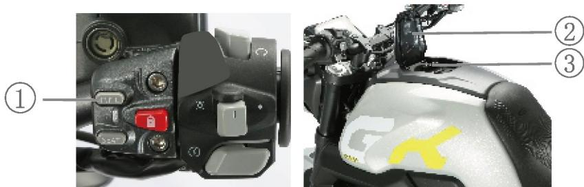
El depósito de gasolina se encuentra delante del asiento. Para repostar gasolina deberá abrir la tapa de acceso al tapón. Asegúrese de que el motor esté parado, y pulse el botón del depósito de gasolina (1), la tapa (2) se abrirá automáticamente, gire el tapón (3) del depósito de gasolina en sentido antihorario. Para cerrar el depósito, siga el orden opuesto al descrito.
