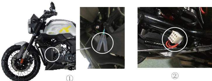
La motocicleta cuenta de serie con un conector situado bajo el depósito de gasolina por el lado izquierdo como muestra la Imagen 1. El conector es del tipo bala hembra y sólo proporciona alimentación cuando el motor está en marcha, pudiendo conectarse faros auxiliares sin dañar los circuitos eléctricos originales.
