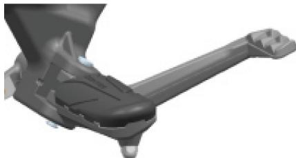
Presione el pedal del freno trasero, la rueda trasera frenará y se iluminará la luz de freno a la vez.
