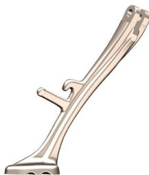
Cuando use el caballete lateral, al desplegarlo se cortará el encendido del motor a no ser que mantenga accionada la maneta del embrague con el cambio en punto muerto.
