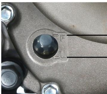
Para conseguir la máxima durabilidad del motor, es muy importante utilizar aceite motor de alta calidad y cambiar el aceite según se indica en la tabla de mantenimiento. Comprobar el nivel de aceite y cambiarlo periódicamente son dos importantes tareas del mantenimiento de la motocicleta.
