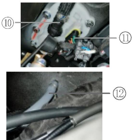
9. Retire el tubo de gasolina a alta presión (10) y la unión de la bomba de gasolina (11).
