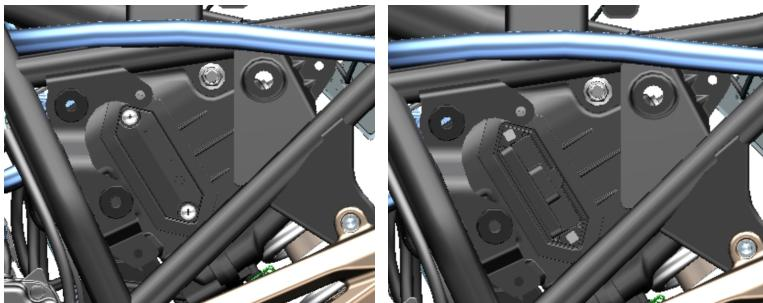
El filtro del aire se encuentra bajo el asiento. Si el filtro del aire está sucio, puede hacer que se obstruya el paso del aire de admisión, baje la potencia y aumente el consumo de combustible. Si conduce en zonas polvorrientas, deberá aumentar la frecuencia de limpieza del filtro del aire o su cambio. Complete los siguientes pasos para realizar la limpieza del filtro del aire.
