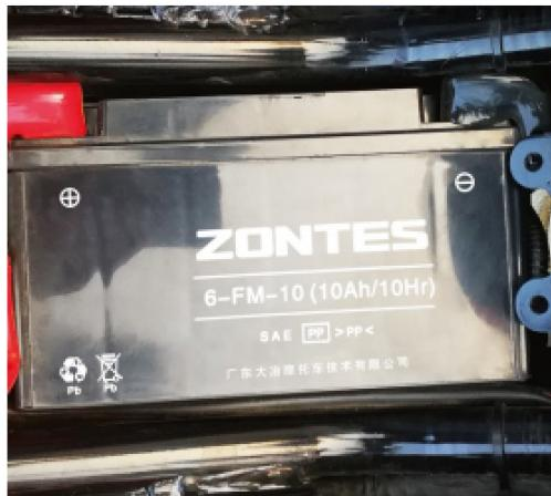
La batería se encuentra debajo del asiento del piloto. Se trata de una batería de gel-plomo sin mantenimiento. Para su primer uso, conecte los bornes positivo y negativo y monte el tirante de goma.
