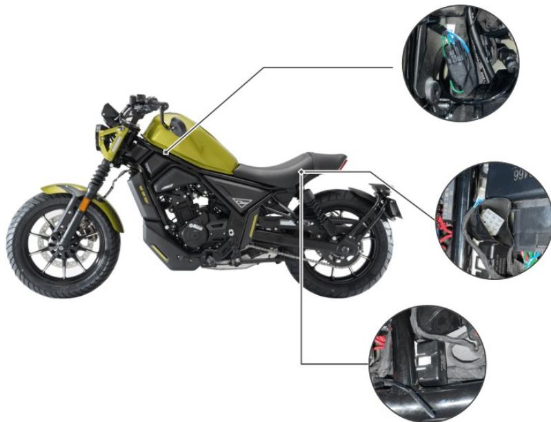
La motocicleta cuenta de serie con un conector situado bajo el depósito de gasolina por el lado izquierdo como muestra la Figura. El conector sólo proporciona alimentación cuando el motor está en marcha, pudiendo conectarse faros auxiliares sin dañar los circuitos eléctricos originales.
