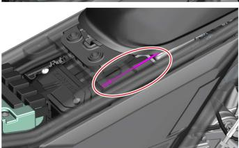
Desconecte el conector situado entre la placa de protección del cierre del depósito y el cable.
