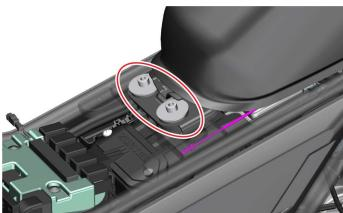
Desconecte el conector del piloto trasero (en la parte derecha bajo el asiento) y retire el asiento.
