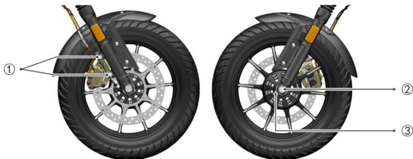
Par de apriete del eje delantero: 55 Nm
