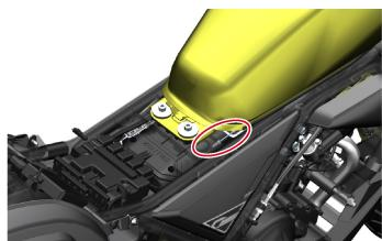
Desconecte el conector situado entre la placa de protección del cierre del depósito y el cable.
