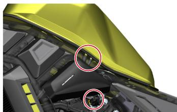
Levante ligeramente la parte posterior del depósito y retire el tubo de absorción de gasolina y el de aliviadero de la parte izquierda del depósito.
