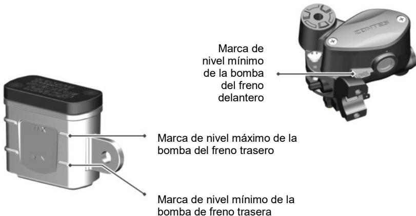
Compruebe el nivel de líquido de frenos en los depósitos de las bombas de freno delantera y trasera. Si el nivel del líquido de frenos está por debajo de la marca LOWER, compruebe el desgaste de las pastillas y si aparecen fugas de líquido de frenos.
