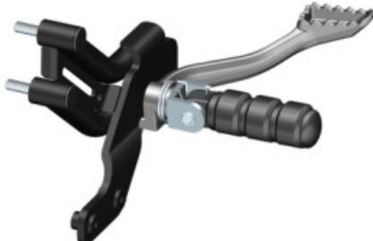
Presione el pedal del freno trasero, la rueda trasera frenará y se iluminará la luz de freno a la vez.
