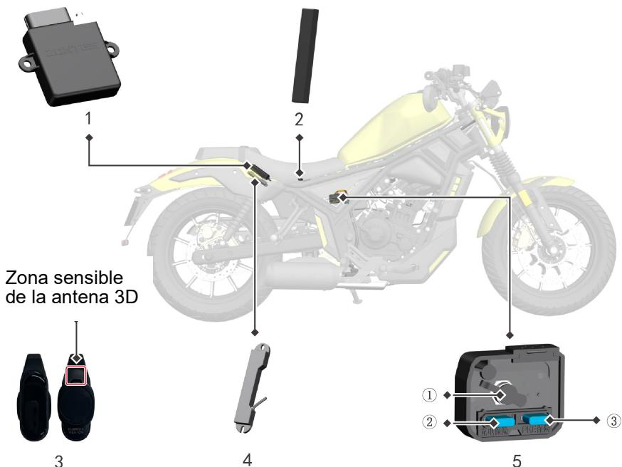
Hay dos componentes en el sistema PKE, el controlador (Imagen 1) la antena emisora de baja frecuencia (Imagen 2), la llave (Imagen 3), la antena inductiva (Imagen 4) y los accesorios del PKE (Imagen 5).
