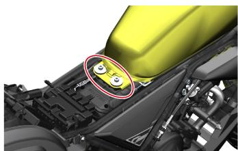
Desconecte el conector del piloto trasero (en la parte derecha bajo el asiento) y retire el asiento.
