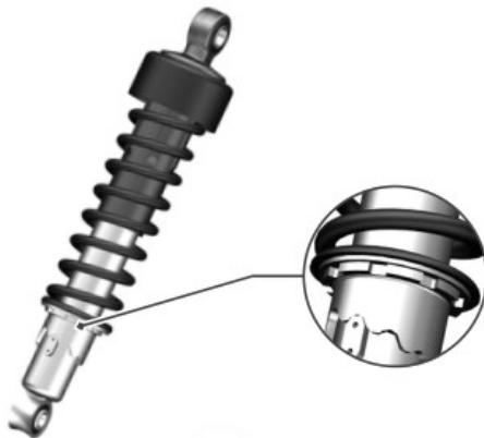
El muelle del amortiguador trasero se ajusta según las necesidades de conducción, la carga y el estado de la carretera. Para ello solo necesita detener la motocicleta con el caballete lateral. Ajuste la precarga del muelle a la posición deseada. La rigidez disminuirá cuando lo ajustemos hacia abajo y aumentará cuando la ajustemos hacia arriba.
