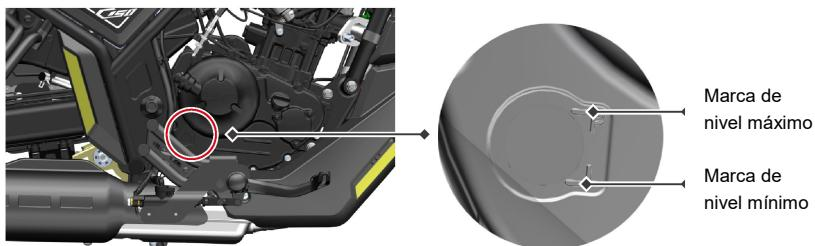
Para conseguir la máxima durabilidad del motor, es muy importante utilizar aceite motor de alta calidad y cambiar el aceite según se indica en la tabla de mantenimiento. Comprobar el nivel de aceite y cambiarlo periódicamente son dos importantes tareas del mantenimiento de la motocicleta.
