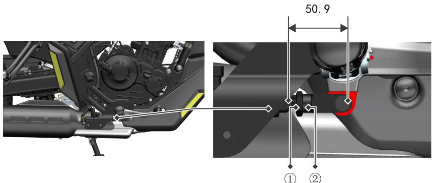
El pedal de freno se debe mantener en una posición adecuada. De lo contrario, las pastillas siempre estarían rozando con el disco, lo que dañaría pastillas y disco. Ajuste la posición del pedal de freno de la siguiente manera:
