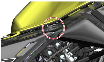
Desconecte el conector de la bomba de gasolina por el lado derecho del depósito.
