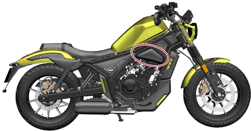
La dotación de herramientas se encuentra por el lado derecho del vehículo. Retire la cubierta decorativa para acceder a la dotación de herramientas, como muestra la figura.
