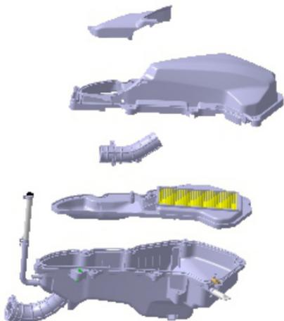
El filtro de aire se encuentra sobre el motor. Si está obstruido por el polvo, reduce la entrada de aire, lo que disminuye la potencia y aumenta el consumo de combustible.
