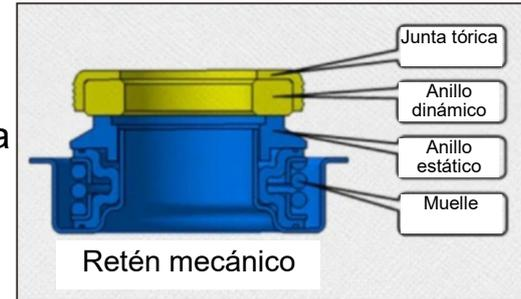
El anillo estático se adhiere firmemente al anillo dinámico bajo la fuerza del muelle, que produce presión en la superficie y luego se produce un sellado móvil fiable. Cuando la bomba de agua está funcionando, los anillos dinámico y estático se deslizan relativamente, por lo que no podría sellarse por completo. Esto puede producir una pequeña fuga de una gota de agua a través del orificio del aliviadero. Esto es normal, y para nada perjudicial para la conducción sin dañar al scooter.
