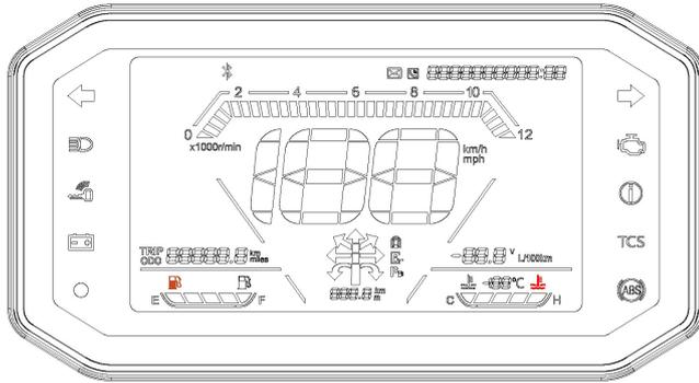
**Velocímetro:** Muestra la velocidad de cruceo del scooter. (km/h: kilómetros/hora o mph: millas/hora).
