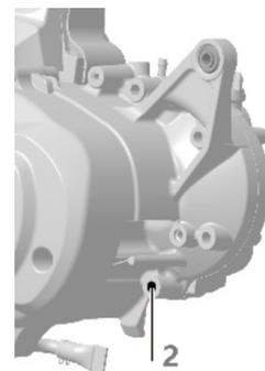
Si el nivel de aceite de la transmisión (o reductora) es demasiado alto, retire el tornillo de drenaje de aceite de transmisión (2 en Figura 2) con una llave de vaso.
