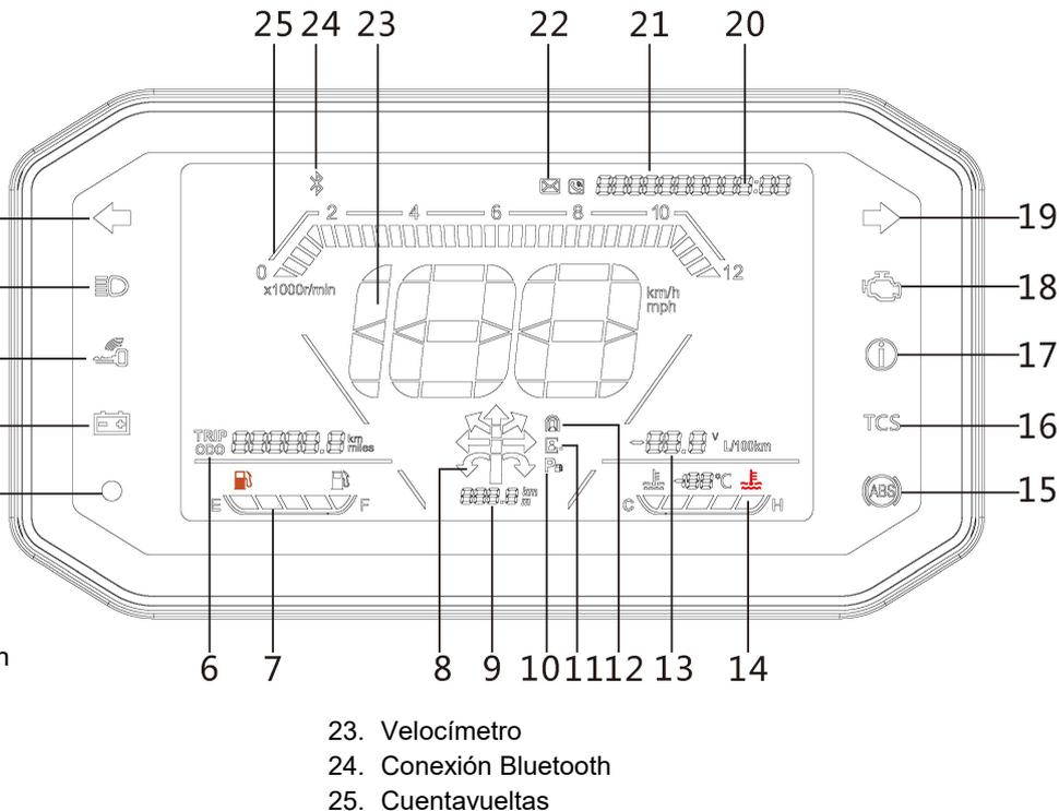
Gire el pomo de contacto a la posición "C" y el panel de instrumentos comenzará su autocomprobación. Los testigos "E" y "ABS" de anomalía del sistema de inyección se iluminará y el del ABS parpadeará.
