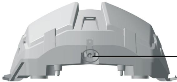
Tornillo de ajuste del haz del faro
