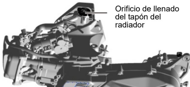
Orificio de llenado del tapón del radiador
