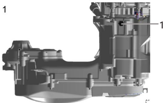
En caso de que el nivel de aceite motor sea demasiado alto, retire el tornillo de drenaje de aceite motor (1 en Figura 1) con una llave de vaso (la posición del tornillo se muestra en la imagen, en el lado inferior derecho del motor).
