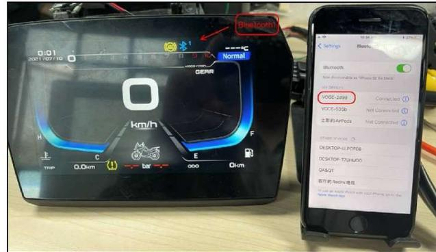
4.2 Abra la App VOGÉ Global, haga clic en el ícono de Bluetooth de (BLE-VOGE-) para comenzar la conexión, cuando se conecte correctamente, el testigo de Bluetooth cambiará al color amarillo, la pantalla del panel de instrumentos iluminará el testigo Bluetooth 2. En este momento, pulse el botón Debajo de la motocicleta para pasar a la página de la navegación.
