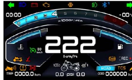
2. Conexión Bluetooth. Abra la configuración Bluetooth en el móvil y busque el nombre del Bluetooth. Cuando esté conectado, el testigo de Bluetooth en la pantalla del panel de instrumentos se iluminará. En este momento, la pantalla del panel de instrumentos puede mostrarle el nombre de la persona que le está llamando.
