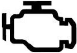
Si se ilumina este testigo significa que hay un mal funcionamiento en el motor. Si continúa conduciendo puede provocar un fallo en el motor o la interrupción del suministro de combustible. Pare el motor, apague el interruptor de encendido y luego arranque nuevamente; en caso de que la luz de alarma se apague, continúe conduciendo; en caso de que aún esté encendida, contacte con el Servicio Autorizado
