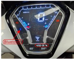
Abra la App VOGÉ Global, haga clic en el ícono de Bluetooth para comenzar la conexión de Bluetooth 4200. Cuando se conecte correctamente, se iluminará el testigo de Bluetooth.
