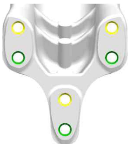
Figura 1: posiciones de ajuste en la tija superior
