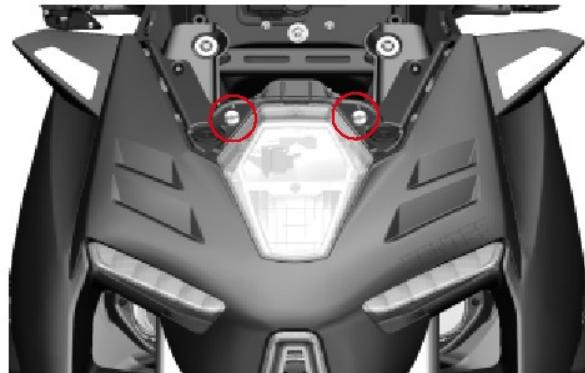
8. Afloje los dos tornillos y retire el panel frontal.
