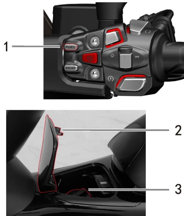
El depósito de gasolina se encuentra delante del asiento en el interior del túnel central. Cuando tenga que repostar combustible, confirme que el motor está parado (interruptor cortacorrientes en OFF). Pulse el botón ① de apertura de la tapa del depósito en la piña de commutadores derecha y la tapa del depósito ② se abrirá automáticamente. Abra el tapón del depósito ③ girándolo en sentido antihorario. Vuelva a cerrar el tapón y la tapa del depósito en el orden inverso.
