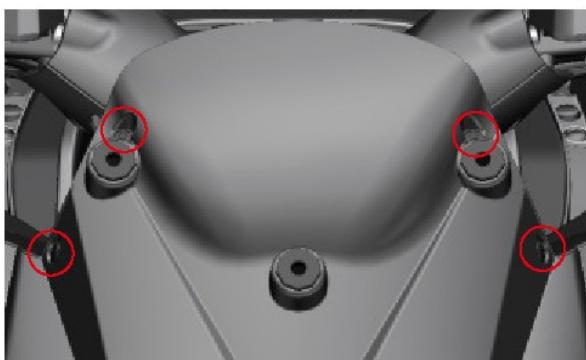
7. Retire las cuatro grapas y retire la cubierta frontal.
