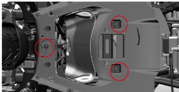
14. Afloje la parte delantera del recubrimiento hacia abajo, y luego tire hacia atrás de la parte inferior del recubrimiento. Preste atención a los tres topes de la figura.
