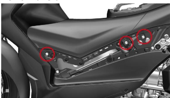
3. Afloje los tres tornillos y retire suavemente la parte izquierda de la cubierta del depósito de gasolina de derecha a izquierda. Retire la parte
