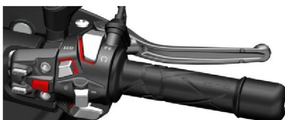
El pulsador de luz de freno delantero se encuentra en la maneta del freno delantero. La luz de freno en el piloto trasero se ilumina cuando comienza a accionar la maneta con una suave presión.
