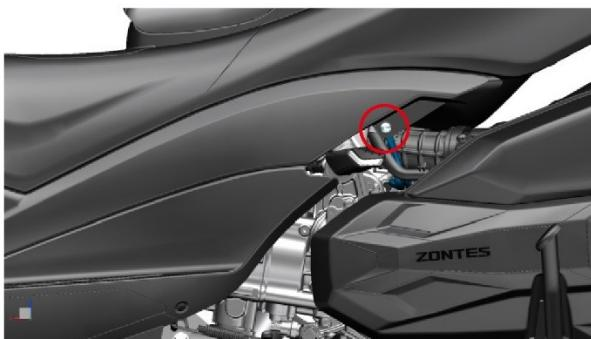
2. Afloje el tornillo que fija el lateral izquierdo, retire suavemente el lateral izquierdo y retire el lateral derecho de la misma manera.
