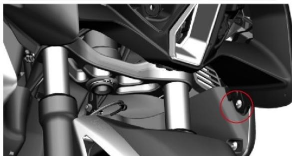
10. Afloje los tres tornillos y retire el panel frontal izquierdo. Retire el panel frontal derecho de la misma manera.
