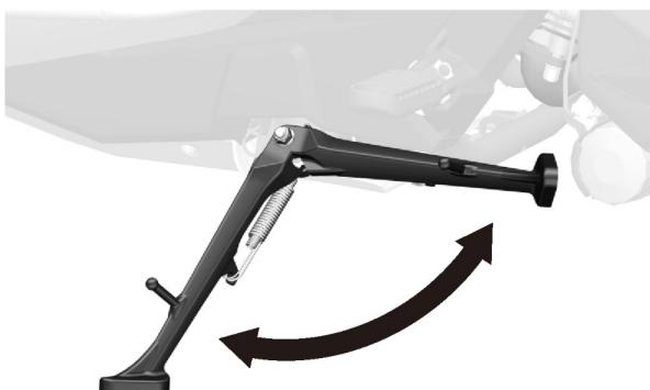
Cuando el caballete lateral está extendido o apoyado, el interruptor de seguridad del caballete lateral cortará el encendido y el motor se parará. Tampoco funcionará el motor de arranque hasta que lo recoja.
