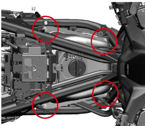
12. Desconecte el tubo de gasolina y el cableado de la parte inferior del depósito, incluyendo el tubo de absorción al cánister de la parte inferior del depósito, el tubo de gasolina a alta presión, el cableado de la bomba de gasolina y el cableado del aforador en la parte delantera del depósito.
