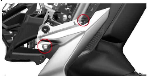
12. Retire la unión y los dos tornillos.
