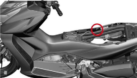
Afloje la grapa (detrás de la unión entre la cubierta del depósito y los faldones traseros izquierdo y derecho) y un tornillo roscachapa, y saque las partes izquierda y derecha de la cubierta del depósito hacia fuera.
