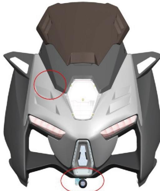
Como se muestra en la figura, el puerto a modificar se encuentra en el interior del escudo frontal para lo cual tendrá que desmontarlo. La cámara y su controlador se conectarán al conector impermeable sin modificar la instalación eléctrica original. La figura muestra la posición de instalación del soporte modificado.
