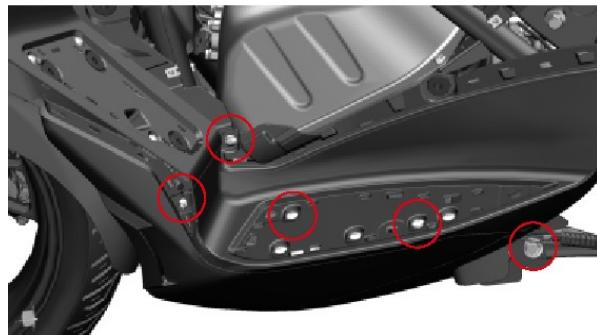
Afloje los siete tornillos y las tres uniones. Retire un casquillo antiquemaduras, retire la plataforma izquierda y la cubierta decorativa de la plataforma. Retire la plataforma derecha y la moldura derecha. Ya que el vaso de expansión se encuentra en la plataforma derecha, preste atención para evitar fugas del vaso de expansión.
