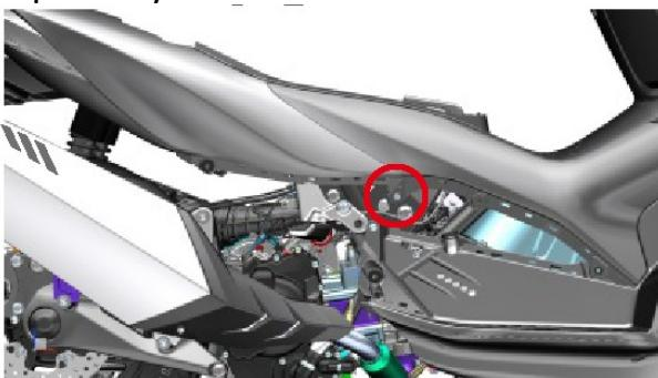
5. Afloje un tornillo M6 de las partes izquierda y derecha de la cubierta del depósito de gasolina.
