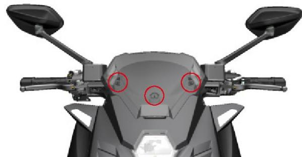
6. Preste atención a las tres tuercas ciegas de la imagen y retire el parabrisas.
