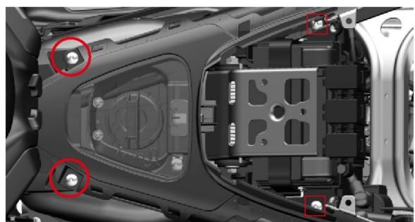
5. Afloje los dos tornillos de la cubierta del túnel central del depósito, y retire las
