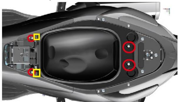
2. Afloje los cuatro tornillos M6 del compartimento de carga y retire las dos uniones, retire el portabultos trasero y desconecte el conector del alumbrado interior del compartimento.
