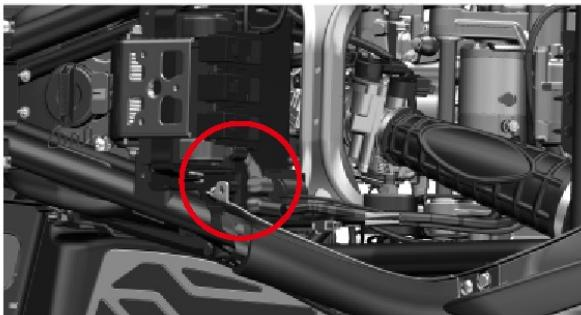
Abra la tapa del depósito de gasolina, afloje el tornillo de fijación de la tapa del depósito, desconecte la electrónica de apertura y la tapa. Desmonte la parte del túnel central de la placa y finalmente retire el tapón de llenado del depósito.
