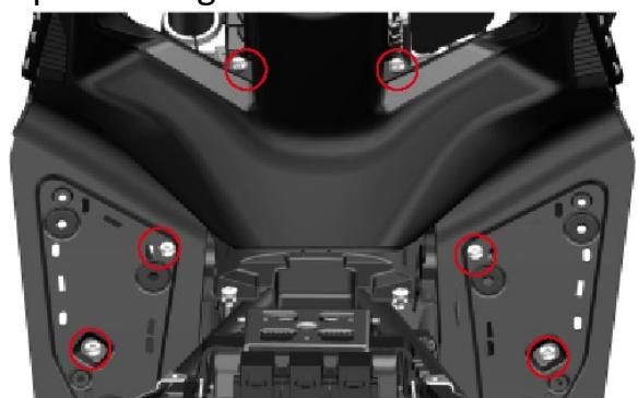
15. Abra las guanteras y afloje los seis tornillos y retire el panel de las guanteras como un conjunto.
