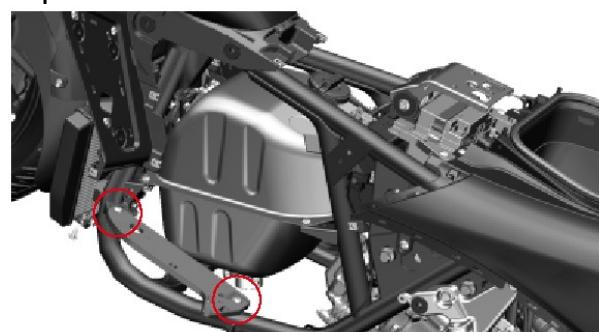
Retire la placa que soporta la plataforma derecha de la misma manera.
