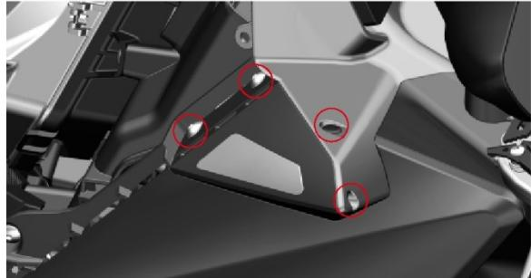
9. Retire el tornillo de expansión, los dos tornillos y el tornillo roscachapa y afloje el intermitente izquierdo. Retire el intermitente derecho de la misma manera.
