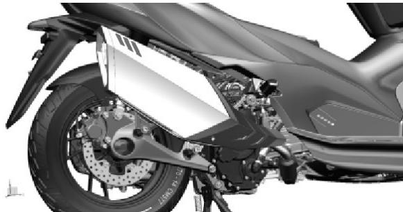
4. Abra las estriberas izquierda y derecha, afloje el tornillo M6 y la unión de las cubiertas izquierda y derecha respectivamente, y saque las cubiertas izquierda y derecha.
