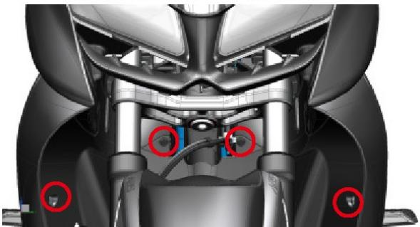
7. Afloje los dos tornillos roscachapa y los cuatro tornillos de expansión del panel frontal y saque el panel frontal hacia fuera.
