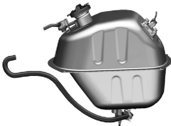
13. Retire los cuatro tornillos M6 que fijan en su sitio el depósito y retire el tapón del depósito, ajuste el depósito en una posición adecuada y sáquelo. Después de retirar el depósito, cubra la parte trasera del depósito para evitar que salpique la gasolina.
