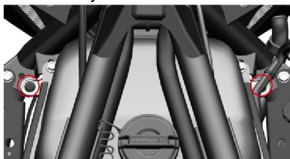
16. Retire las dos uniones que fijan el deflector de aire del electroventilador y saque el deflector de aire del electroventilador.
