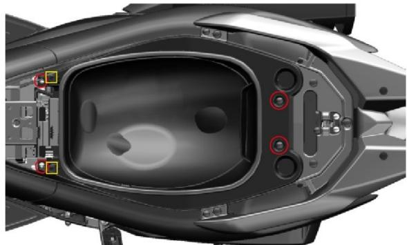
4. Retire los dos tornillos decorativos del emblema, afloje los dos tornillos delantero y los dos traseros del compartimento de carga, y retire las dos pestañas que fijan los faldones derecho e izquierdo a la parte delantera del compartimento de carga.
