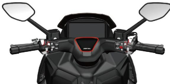
Como se muestra en la figura, el conector a modificar se encuentra en la parte inferior del manillar. Necesitará desmontar las cubiertas superior e inferior del manillar. El conector es impermeable y solo estará operativo cuando el motor esté en marcha. Los puños calefactables originales se pueden montar sin modificar el cableado original.
