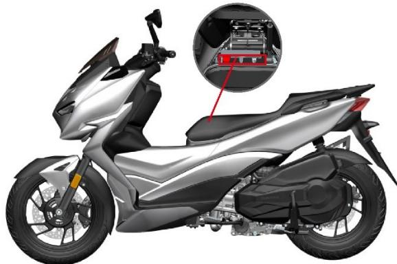
El fusible principal y un fusible de repuesto se localizan sobre el relé de arranque, fusible ECM, fusible de la alimentación normal, fusible del motor del ABS, fusible de la ECU del ABS, fusible de la bomba de gasolina, fusible de arranque, fusible del ABS, fusible auxiliar, otros fusibles y cuatro fusibles de repuesto.
