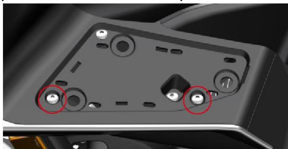
Afloje los dos tornillos. Repita el proceso para el lado derecho.
