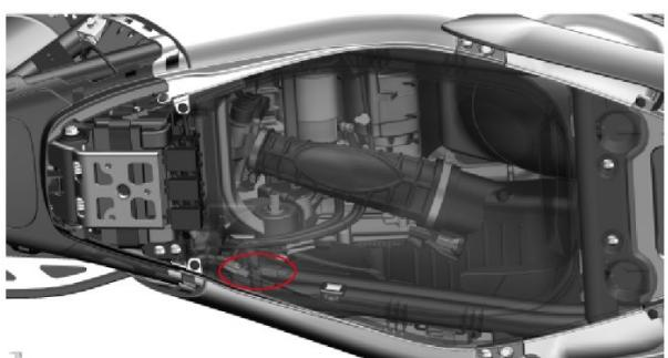
Levante el compartimento de carga desde la parte trasera y tire de él un poco hacia atrás, desconecte el conector izquierdo de la luz interior del compartimento y retire el compartimento.
