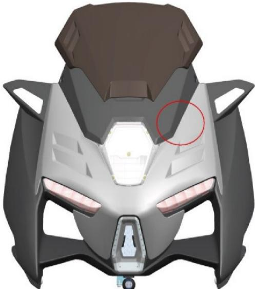
Como se muestra en la figura, el control del motor del parabrisas ha sido preinstalado en el soporte del frontal, y el puerto de modificación del cable se encuentra en el interior del escudo frontal. Necesitará desmontar la placa de
