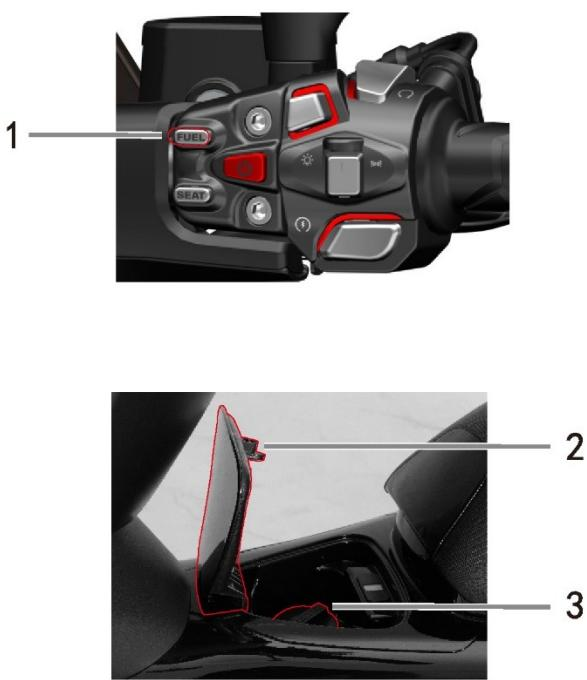
Para acceder a la dotación de herramientas, abra el asiento y la encontrará en el bolsillo posterior del compartimento de carga en la posición mostrada en la figura.
