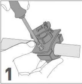
1 Sistema di montaggio. Avvitare al tubolare manubrio
