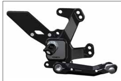
3 pedivella alzata di 16 mm e arretrata di 16mm rispetto alla posizione originale
