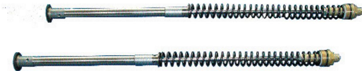
Il kit pompanti forcella per triumph truxton, è composto da due cartucce idrauliche complete di pistoni compressione, estensione e relative lamelle, due molle e due tappi.
